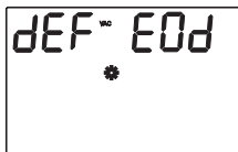
Рисунок 21 — Предел разряда АКБ (EOD)
