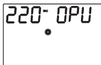
Рисунок 19 — Настройка выходного напряжения
