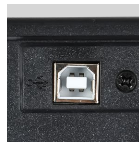
USB-разъем типа B для мониторинга
